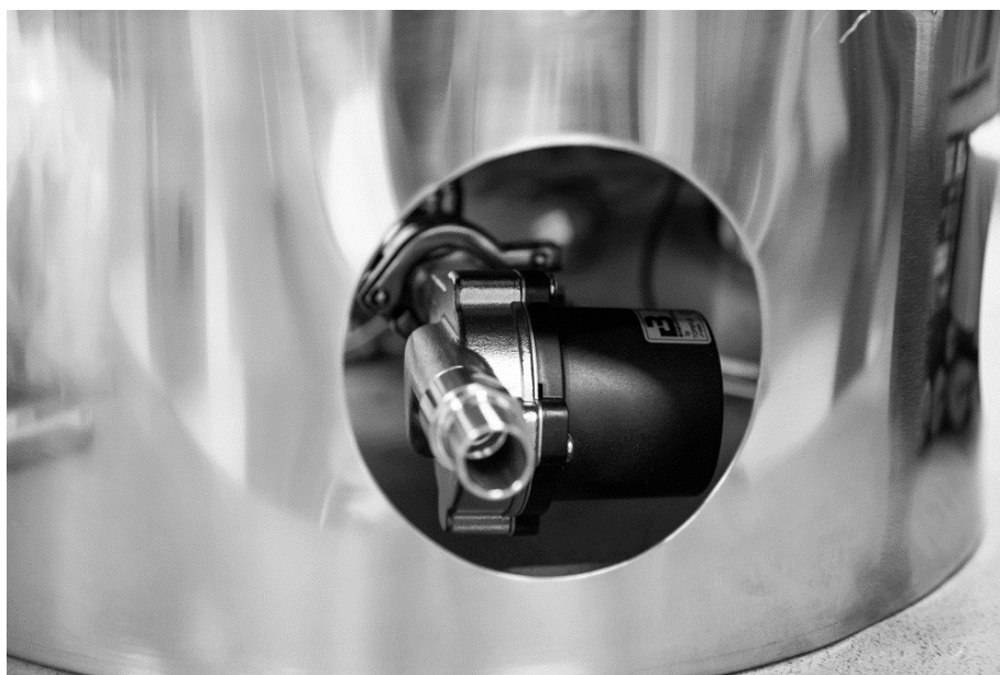
Riktig monteringsposisjon av pumpen
